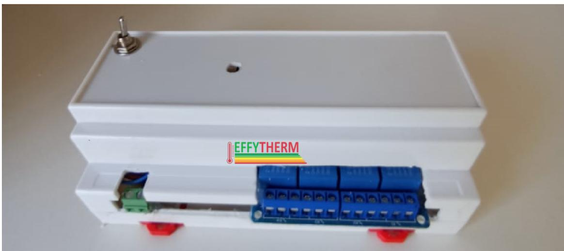
Actuador eléctrico de cuatro puertos con tecnología de Internet de las Cosas (IoT). Puede ser consultado y manejado remotamente hasta con cuatro actuadores multipropósito. Los contactores vienen con las opciones normalmente abierto y normalmente cerrado, dando versatilidad y eficiencia al equipo.
