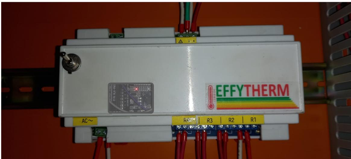
Controlador Lógico Programable y Controlador PID Modelo AA1, es un PLC para el control y monitoreo de los procesos industriales a través de Internet de las Cosas. Incluye 4 controladores PID.
